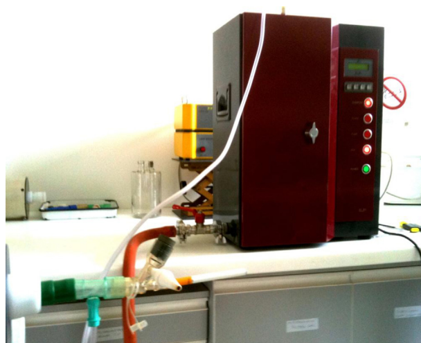
Figure 2. Impacteur électrostatique electrostatic low-pressure impactor à 13 plateaux et dispositif expérimental.
